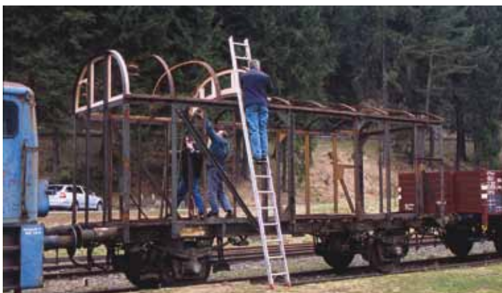
Am Güterzuggepäckwagen 88-31-04 hat die Anfertigung der neuen Holzteile begonnen. Am 20. April wurden Holzteile in das Stahlgerippe des Wagens eingepasst.
